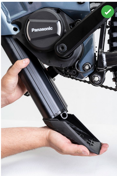
OBRÁZOK 4: SPRÁVNE DRŽANIE BATÉRIE
