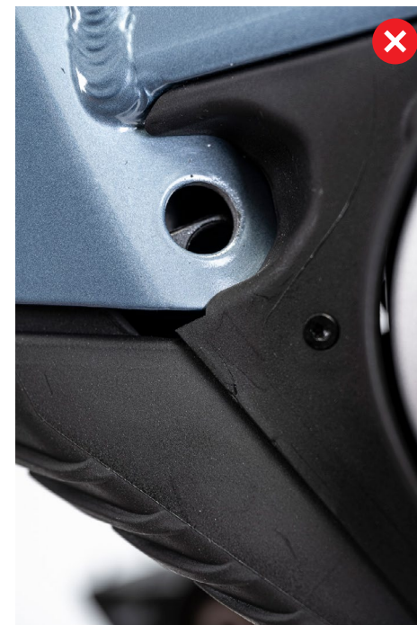
OBRÁZOK 6: OVERENIE SÚSTREDNOSTI DIERY V RÁME A BATÉRIÍ
