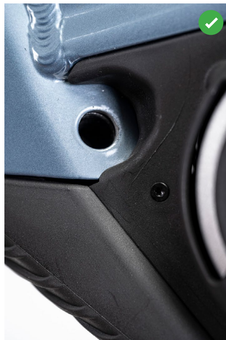
OBRÁZOK 6: OVERENIE SÚSTREDNOSTI DIERY V RÁME A BATÉRIÍ
