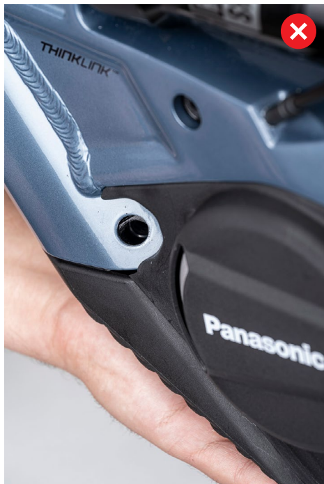
OBRÁZOK 7: OVERENIE PREKRYTIA KRYTU MOTORA KRYTOM BATÉRIE NA ĽAVEJ STRANE (STRANA BŔZD)
