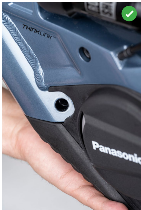
OBRÁZOK 7: OVERENIE PREKRYTIA KRYTU MOTORA KRYTOM BATÉRIE NA ĽAVEJ STRANE (STRANA BŔZD)
