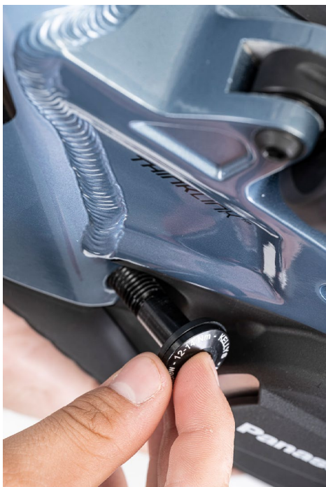
OBRÁZOK 9: VOĽNE VLOŽENÁ SKRUTKA DO RÁMU
