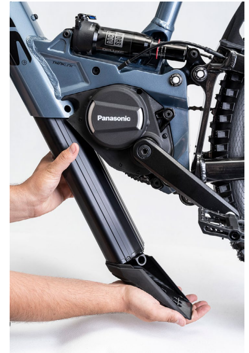
3. ÁBRA: AZ AKKUMULÁTOR HELYES TARTÁSA A KIHÚZÁS SORÁN
