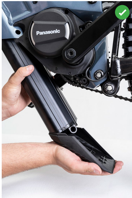
4. ÁBRA: AZ AKKUMULÁTOR HELYES TARTÁSA
