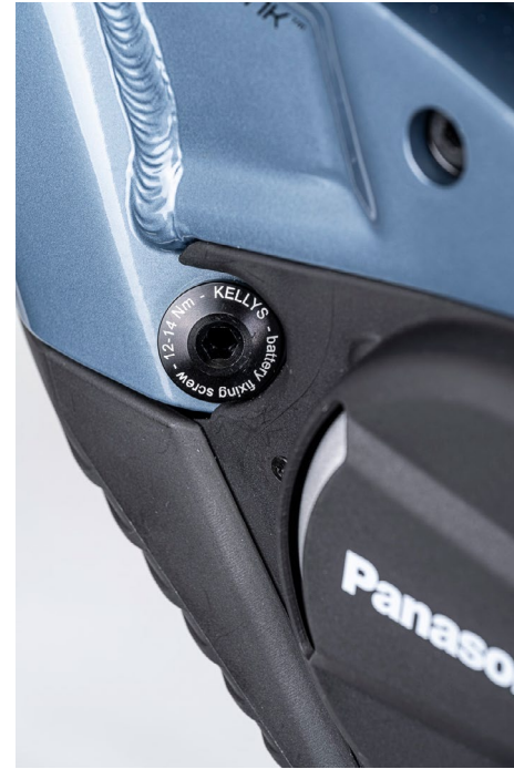
10. ÁBRA: AZ ELŐÍRT NYOMATÉKÚ CSAVAR FEJE
