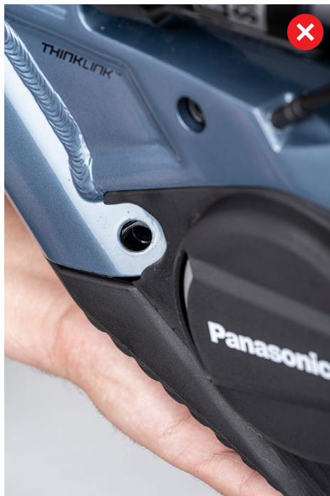
7. ÁBRA: A MOTORBURKOLAT ÉS AZ AKKUMULÁTORBURKOLAT BALOLDALI (FÉKOLDAL) ILLESZKEDÉSÉNEK AZ ELLENŐRZÉSE
