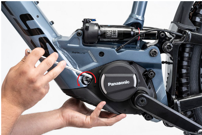
1. ÁBRA: A CSAVAR ELHELYEZKEDÉSE ÉS A TEKERÉS IRÁNYA
