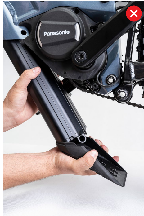
5. ÁBRA: AZ AKKUMULÁTOR HELYTELEN TARTÁSA
