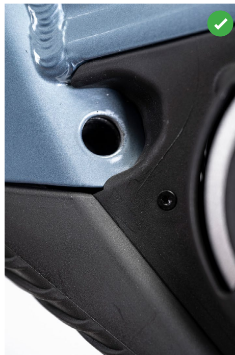
OBRÁZEK 6: OVĚŘENÍ SOUSTŘEDNOSTI DÍRY V RÁMU A BATERIÍ
