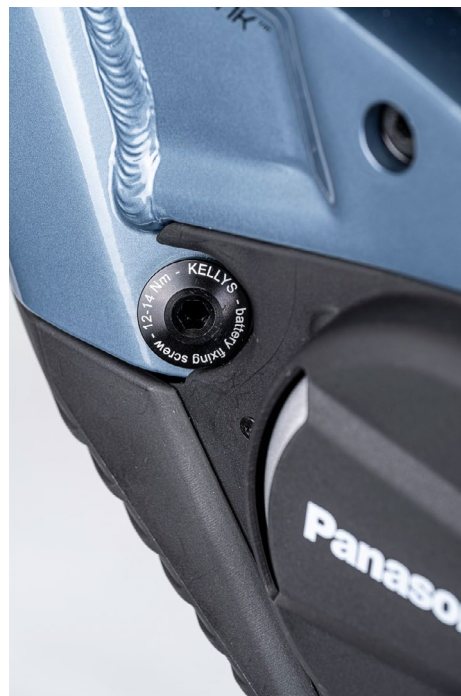
OBRÁZEK 10: HLAVA ŠROUBU S PŘEDEPSANÝM MOMENTEM
