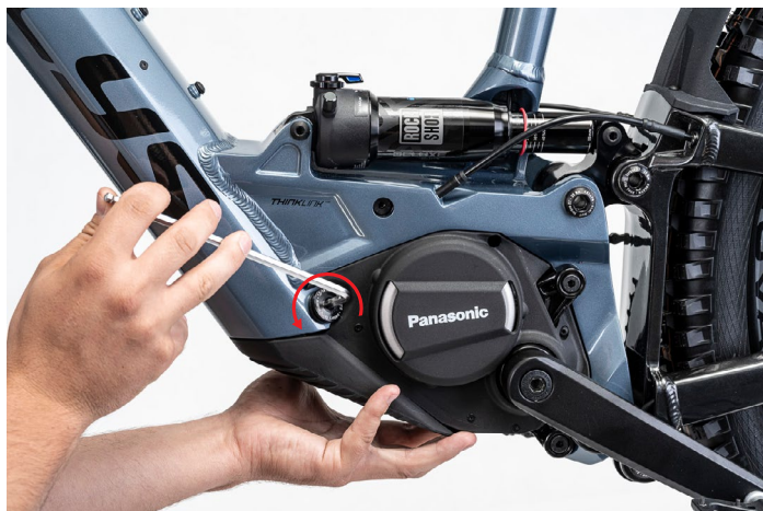
OBRÁZEK 1: UMÍSTNĚNÍ ŠROUBU A SMĚR OTÁČENÍ
