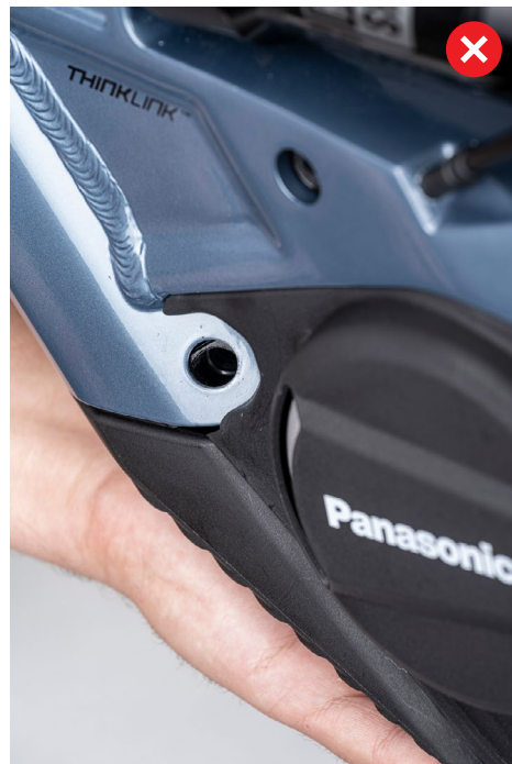
OBRÁZEK 7: OVĚŘENÍ PŘEKRYTÍ KRYTU MOTORU KRYTEM BATERIE NA LEVÉ STRANĚ (STRANA BRZD)
