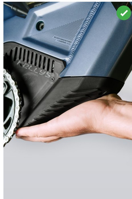
OBRÁZEK 8: OVĚŘENÍ PŘEKRYTÍ KRYTU MOTORU KRYTEM BATERIE NA PRAVÉ STRANĚ (STRANA POHONU)
